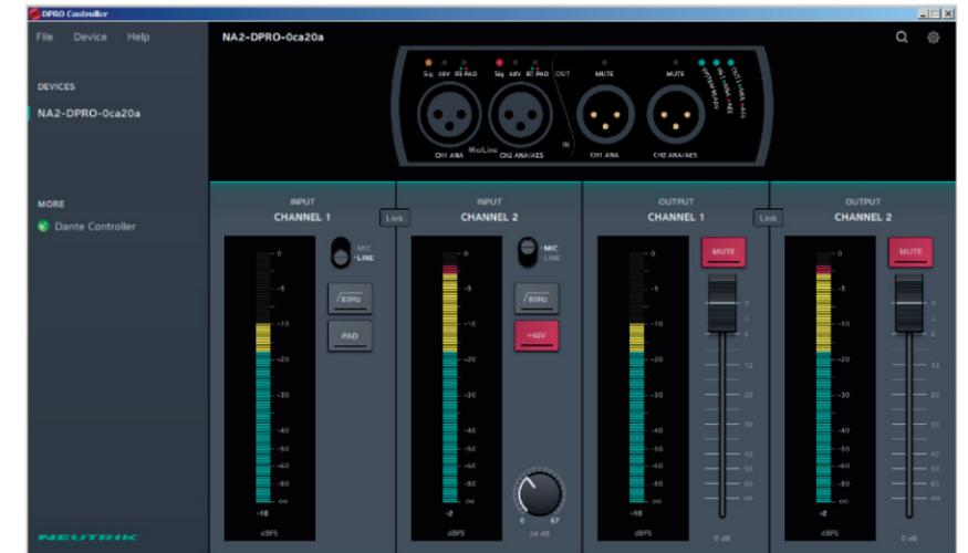
DPRO Controller zur Einstellung des NA2-IO-DPRO. Für die Ein- und Ausgänge gibt es fein aufgelöste Aussteuerungsanzeigen, die ab -18 dBfs gelb und ab -3 dBfs rot leuchten
