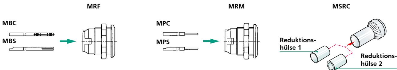
Gehäuse und Einsatz montiert, Kontakte müssen separat bestellt werden.
