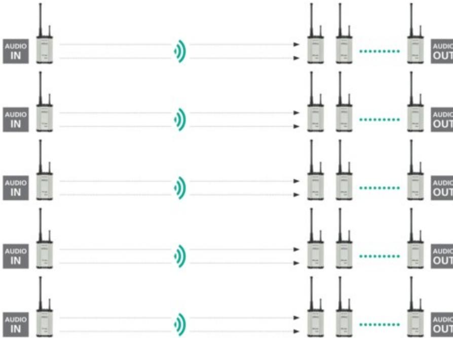
Für das Übertragen von mehreren, unterschiedlichen Audio-Signalen kann das System bis auf sechs Audio-Kanäle ausgebaut werden. Hierfür werden drei TX Sendeeinheiten parallel betrieben. Dieser Aufbau erlaubt eine unlimitierte Anzahl an RX Empfangseinheiten.
