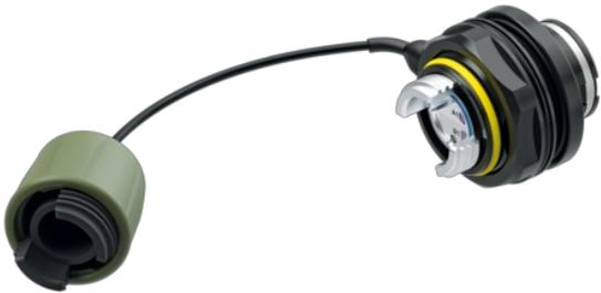
Das FIBERFOX EBC25 2CH Chassis ist ein hermaphroditischer Multimode-Einbaustecker mit „Expanded Beam“ Technologie, der für eine Vielzahl von Anwendungen geeignet ist. Mit seinem Jam-Nut-Design eignet er sich für alle Arten von Industrie-, Verteidigungs- und Regierungs- und sogar Eisenbahnanwendungen.
