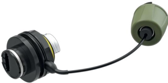
Dank der Expanded-Beam-Technologie und der präzisen optischen Ausrichtung bietet das System eine hohe Immunität gegen Staub, Schlamm, Flüssigkeiten und andere Verunreinigungen. Der FIBERFOX EBC25 2CH Einbaustecker wandelt ein standardisiertes LC-Patchkabel in eine Expanded-Beam-Lösung um. Er fungiert als "Durchgang" und ist mit einer Klemmbuchse ausgestattet.
